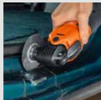
Pilování bez deformace, čisté řezné hrany, tenké linie řezu – výhoda u karosářských prací.
