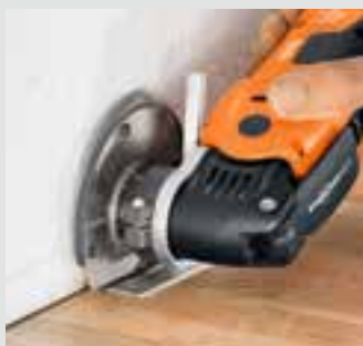
Dilatační spáry lze výborně doříznout.
